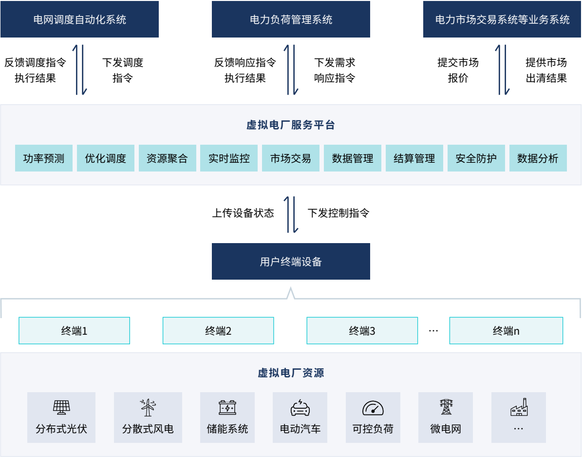
图表 3.1 虚拟电厂服务平台系统结构示意图
