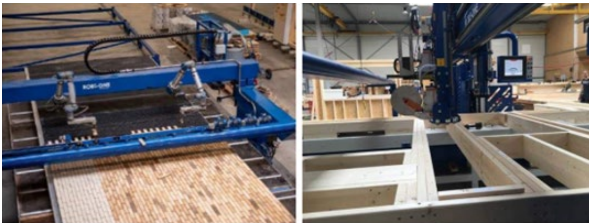
图 5：机器臂外墙包层应用（左）和计算机数控机床（右）制造的木制框架
