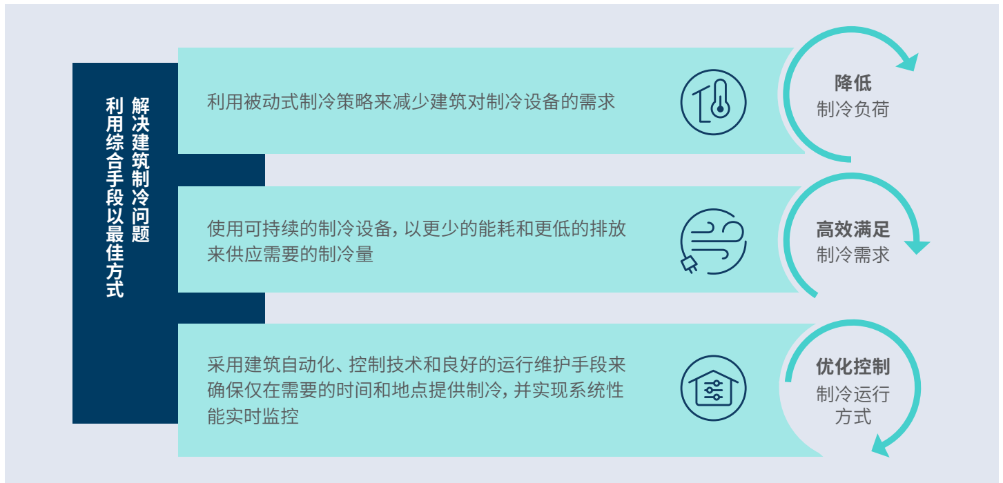
图3 综合性建筑制冷手段
